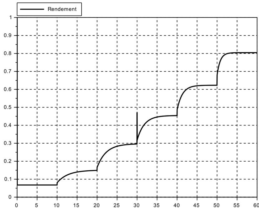
**Question 7 :** Ce système a un rendement très faible lorsque la vitesse du moteur est faible. Il peut donc être utilisé afin de démarrer un moteur mais ne peut pas être utilisé comme un variateur classique. Nous verrons plus tard des solutions permettant d'améliorer les performances de ces systèmes.
