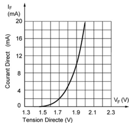
Cette diode a été conçue pour travailler avec un courant  $I_F = 10\text{mA}$ .
