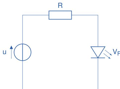
Le constructeur donne les caractéristiques suivantes pour la DEL Everlight Opto 264-7UYC/S530-A2 jaune-orange ronde 3 mm 110 mcd  $40^\circ$  10 mA 1.9V.
